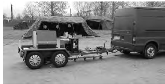
Fig. 11. Bearing capacity tests with use of HWD Rys. 11. Badania nośności przy pomocy HWD
