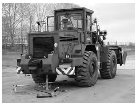
Fig. 10. Displacement modulus tests with use of VSS Rys. 10. Badanie modułu ugięcia przy pomocy VSS
